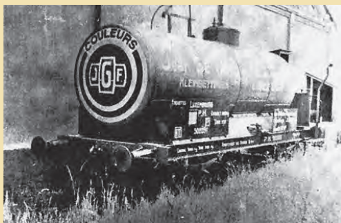
Alter Kesselwagen, in dem Rohstoffe für die Produktion transportiert wurden
